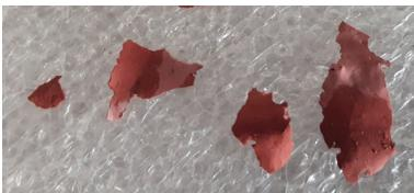
Aquí se muestra la silueta de un recubrimiento de 2 componentes mezclado de forma incompleta.
